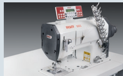
PFAFF 5622 – Doppelkettenstich-Spezialschnellnäher mit Unter- und Nadeltransport
