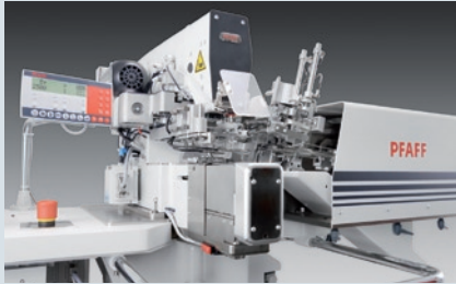
PFAFF 3840 - Nähautomat zum Annähen von Gürtelschlaufen
