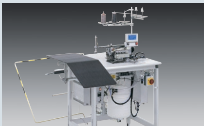
Beisler 1280-5-1 - Nähanlage zum semi-automatischen Nähen von Seiten- und Schrittnähten mit differenzierbarem Ober- und Untertransport
