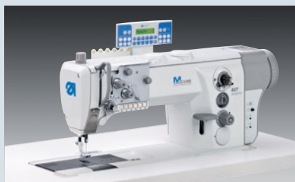
Dürkopp Adler 827-160122-M – Einnadel-Spezialnämaschine mit Unter- und Nadeltransport für dekorative, mehrfädige Nähte
