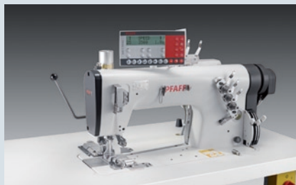
PFAFF 5489-H - Doppelkettenstich-Spezialschnellnäher mit Differential-Untertransport für Kappnähte
