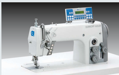
Dürkopp Adler 275-140342-01 – Einnadel-Doppelsteppstichmaschine mit Unter- und differenzierbarem Obertransport – eine voreingestellte Mehrweite über Taster abrufbar (~ 1.250 Kragen in 480')
