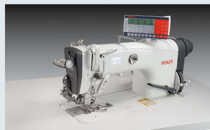
PFAFF 487-19/19 – Einnadel-Doppelsteppstichmaschine mit differenzierbarem Obertransport – eine voreingestellte Mehrweite über Taster abrufbar (~ 830 Hemdensäume in 480'')
