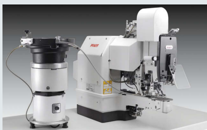
PFAFF 3307-1/11 – Elektronischer Einfachkettenstich-Knopfannäher mit automatischer Knopfzuführung (~ 2.400 Hemden mit 7 Knöpfen auf der Leiste)
