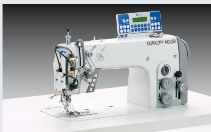
Dürkopp Adler 275-140342-01 (E28) – Einnadel-Doppelsteppstichmaschine mit Unter- und differenzierbarem Obertransport – eine voreingestellte Mehrweite über Taster abrufbar (~ 900 Hemdensäume in 480'')
