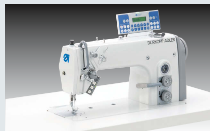
Dürkopp Adler 272-140342-01 – Einnadel-Doppelsteppstichmaschine mit Unter- und Nadeltransport (~ 1.250 Kragen in 480')
