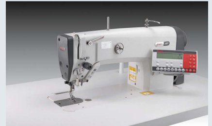
PFAFF 2483 – Einnadel-Doppelstepstichmaschine mit Untertransport und Sensorik zur Erkennung der Stofflagen mit automatischem Setzen des Eckstichs (~ 800 Hemdentaschen in 480')
