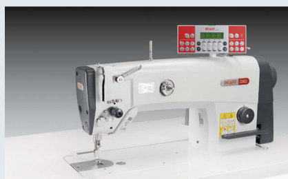
PFAFF 2083 – Einnadel-Doppelstepstichmaschine mit Untertransport zum Ärmleinnähen (~ 420 Hemden in 480')
