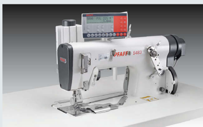
PFAFF 5483-814/01 – Doppelkettenstichmaschine mit Puller für das Annähen und Übersteppen der Rückenpasse (~ 1.000 Rückenpassen in 480')
