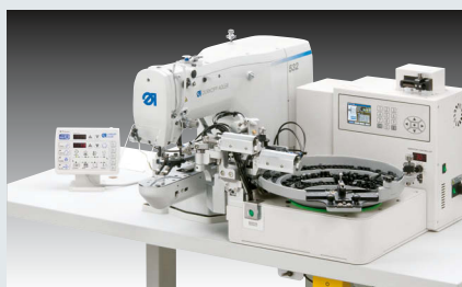
Dürkopp Adler 550-532 – Doppelsteppstich-Knopfannähautomat mit automatischer Knopfzuführung (~ 2.400 Hemden mit 7 Knöpfen auf der Leiste)
