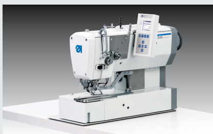
Dürkopp Adler 540-100-01 – CNC gesteuerter Doppelsteppstich-Knopflochautomat (~ 4.000 Stiche/Min.)
