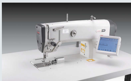
PFAFF 2481 – Einnadel-Doppelsteppstichmaschine mit Unter-, Nadeltransport und Sensorik zur Erkennung der Stoffkanten mit automatischem Setzen des Eckstichs (~ 1.600 Kragen in 480')
