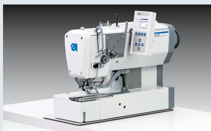
Dürkopp Adler 540-500-01 – CNC gesteuerter Doppelsteppstich-Knopflochautomat mit separat angetriebenem Messer für verlängertes Schneiden bis zum Knopflochriegel (~ 4.000 Stiche/Min.)
