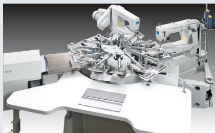
Dürkopp Adler 971-01 – Doppelkettenstich-Nähanlage zum Vornähen und Beschneiden von Manschetten durch Schablonensteuerung (~ 5.000 Manschetten in 480')
