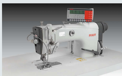
PFAFF 487-104/02 – Einnadel-Doppelstepstichmaschine mit differenzierbarem Obertransport – eine voreingestellte Mehrweite über Taster abrufbar (~ 550 Hemden in 480')
